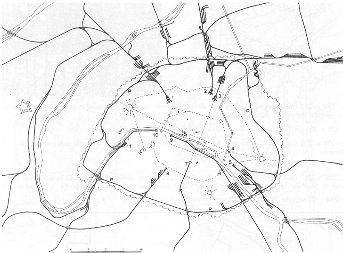
Il sistema ferroviario e dei terminals : 1. Gare St Lazare; 2. Gare du Nord; 3. Gare de l’Est; 4. Gare de la Bastille; 5. Gare de Lion; 6. Gare d’Austerlitz; 7. Gare de Luxemburg; 8. Gare Montparnasse; 9. Gare d’Orsay; 10. Gare des Invalides; 11. Gare Champ de Mars; P. cintura ferroviaria. (SICA 1980, p. 198)
